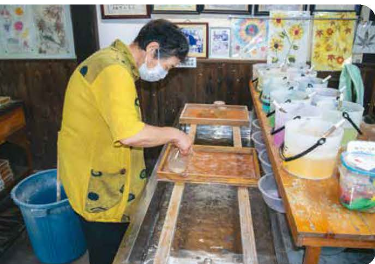
木枠に原料を入れ厚さが均等になる様に流す
